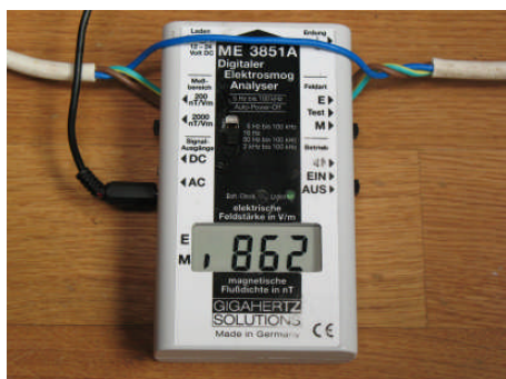
Fig.4. Simulatie van een Gigahertz Solutions ME 3851ME meter, geplaatst in een snoerlus waar stroom zorgt voor een magnetisch wisselveld. De meter AC output wordt naar een oscilloscoop geleid.
